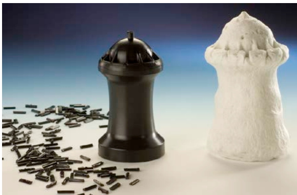
Abbildung 4: Links im Bild die zehn Millimeter langen Langglasfaser-Granulate. Schwarz der mit Langglasfasern gefüllte Prüfkörper. Rechts die verbleibende Faserfilzstruktur des unter hoher Hitze veraschten Prüfkörpers.
