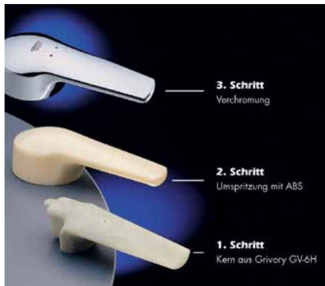
Bild 1. Hochbelasteter Verstellhebel aus PPA, umspritzt mit ABS und verchromt
