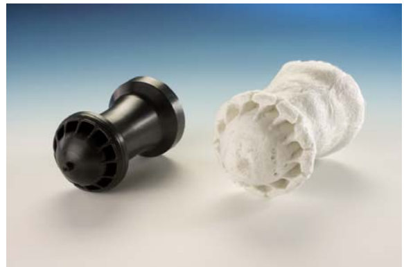
Metallersatz heute: Langfaserverstärkte Polyamide ermöglichen eine sehr hohe Festigkeit und einen geringen Verzug. Rechts im Bild das Faserskelett eines verachteten Bauteils.
