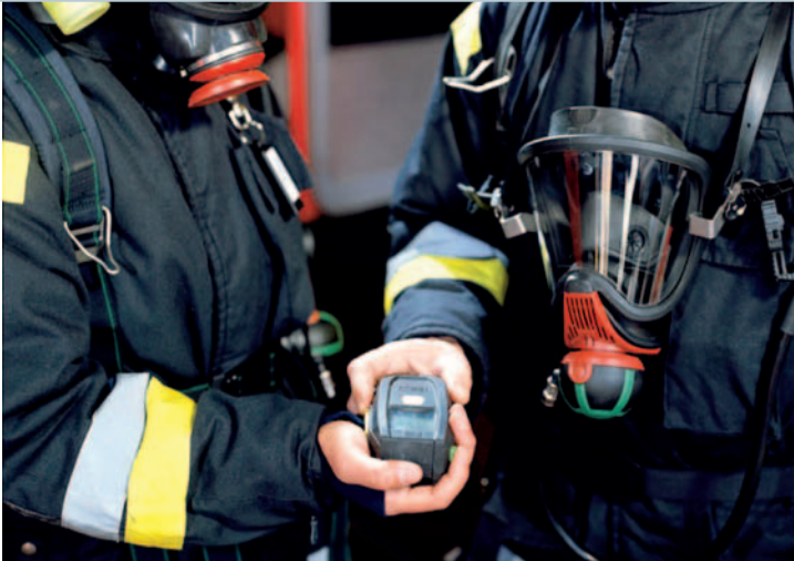
Bild 4. 2K-Schutzmaske aus Hochleistungspolyamid mit umlaufender Kautschukdichtlippe
